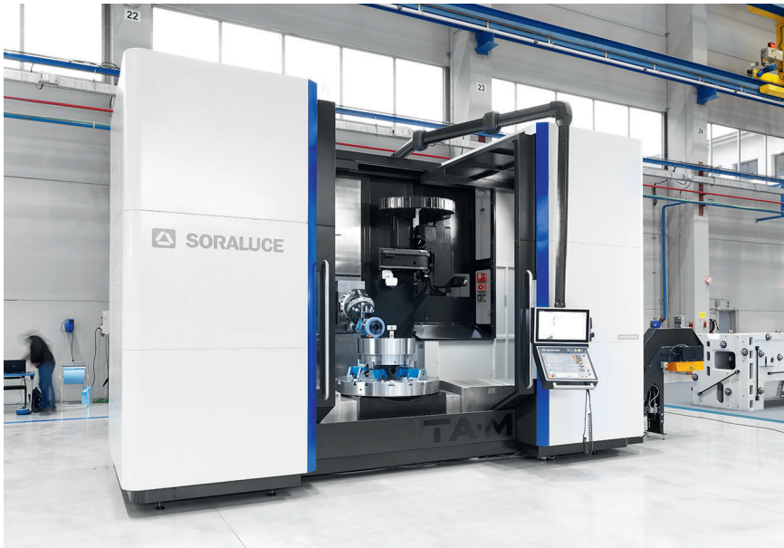
2 Die neue Kompaktbaureihe an Multitaskingmaschinen für die Komplettbearbeitung komplexer Werkstücke in einer Aufspannung (© Bimatec Soraluce)
