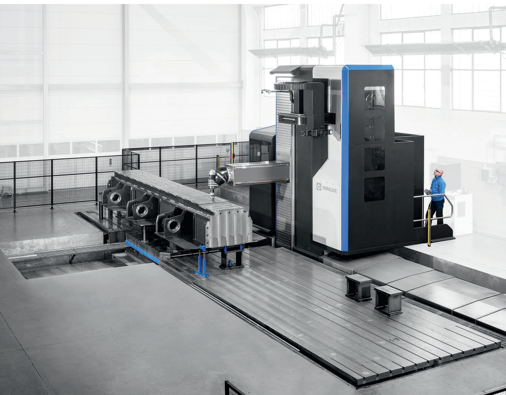
1 Zeitgemäße Großteilebearbeitung: Fahrständer-Fräs- und Bohrzentrum FP
